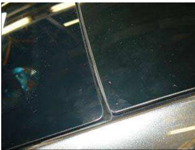
● 如旁边的照片所示，检查并确认挡风玻璃密封件相对于全景式天窗正确对齐。
