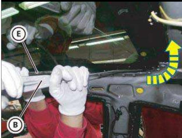
● 从车辆内部，让垫片 (E) 提起玻璃，将工具（带 Equaliser 长刀片（专利号 4955124）的 Excalibur 6 气动切割器）(B) 置于后底角开始处，然后尽可能从车身底角末端切断密封胶。
