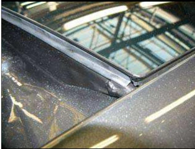
● 如旁边的照片所示，检查并确认全景式天窗的后部密封件正确安装。
