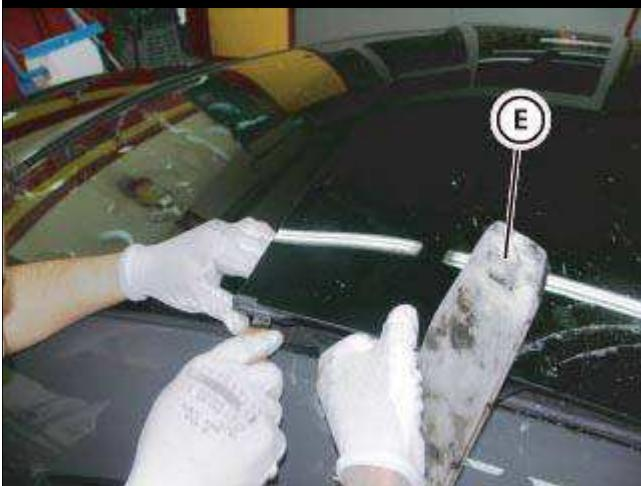
● 使用垫片 (E) 提起玻璃后部，并使用刮刀去除密封胶残渣。
